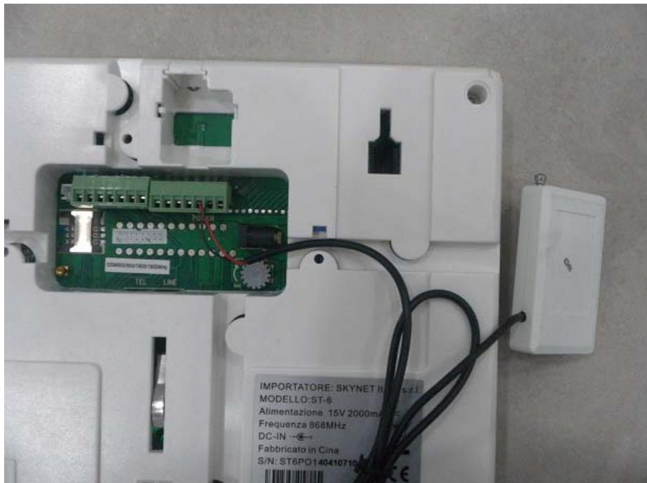
Fornire alimentazione alla sirena esterna,prelevando l'alimentazione direttamente dalla centrale di allarme dai piedini GND(-) +12(+) oppure usando un alimentatore da 12 volt che porta già l'attacco pronto per essere collegato alla sirena ad esempio io nostri modelli da 500 mA o 1500 mA.
